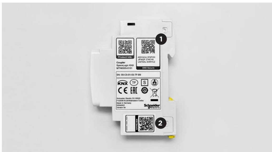
Figura 4.1-2 Esempio di certificato su un accoppiatore di linea. Un certificato del dispositivo ❶ è applicato in modo fisso sul dispositivo, il secondo ❷ certificato può essere rimosso durante la progettazione, prima dell'integrazione in un distributore.
