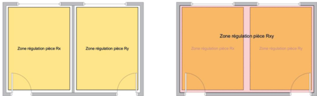
Figure 11: Étude des zones de chauffage/ventilation/climatisation (source: ahochn)
